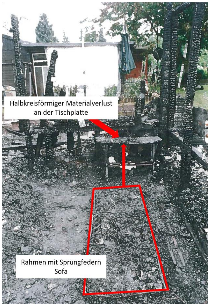
Abbildung 3 Im Vordergrund der Sprungfederrahmen des Sofas, im Bildhintergrund der Tisch mit Brandzehrung [Foto: LKA, Bild 53]
