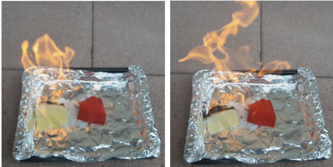
Abbildung 8 Brandversuche mit Polyester-Füllwatte, Baumwoll- und Polyester/Baumwolle-50%/50%-Mischgewebe nach Übergießen mit ca. 20 ml Brennspritus
